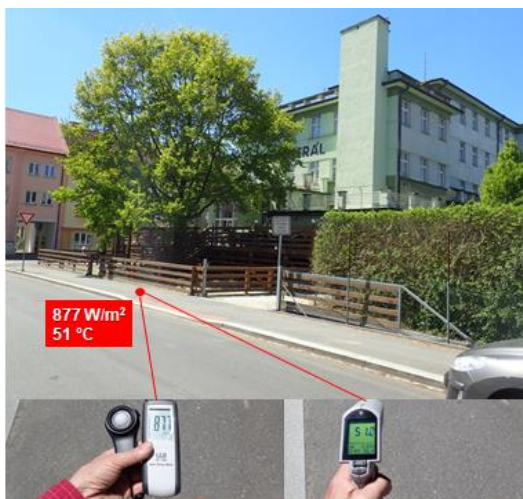
Obr. 5. Intenzita slunečního záření na osluněném chodníku je 877 \text{ W} \cdot \text{m}^{-2} a povrchové teploty 51,2^\circ \text{C} . Ve stínu stromu je intenzita slunečního záření 82 \text{ W} \cdot \text{m}^{-2} a povrchová teplota 26,9^\circ \text{C} . Při transpiračním toku 20 litrů za hodinu chladí strom sebe a své okolí výkonem 14 \text{ kW} .
