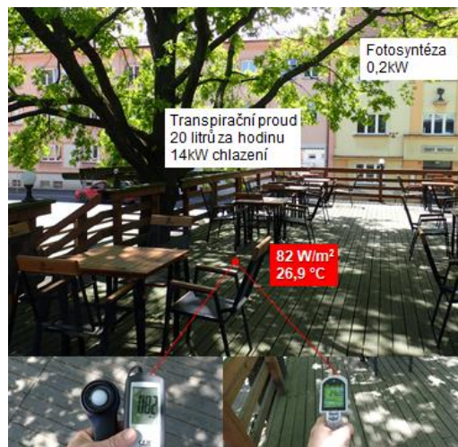
Obr. 5. Intenzita slunečního záření na osluněném chodníku je 877 \text{ W} \cdot \text{m}^{-2} a povrchové teploty 51,2^\circ \text{C} . Ve stínu stromu je intenzita slunečního záření 82 \text{ W} \cdot \text{m}^{-2} a povrchová teplota 26,9^\circ \text{C} . Při transpiračním toku 20 litrů za hodinu chladí strom sebe a své okolí výkonem 14 \text{ kW} .
