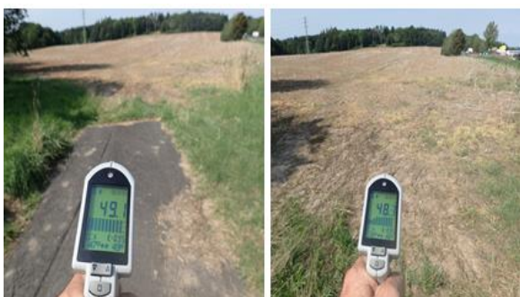
Obr. 6. Benešovsko 26. 8. 2017, intenzita dopadajícího slunečního záření 650 \text{ W} \cdot \text{m}^{-2} . Srovnání povrchové teploty asfaltu ( 49,1^\circ \text{C} ) a navazujícího sklizeného pole ( 48^\circ \text{C} ). Měřeno okolo 15:00 SEČ
